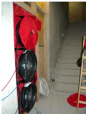
Bild 5: BlowerDoor MultipleFan (3 Ventilatoren) im Treppenhaus
