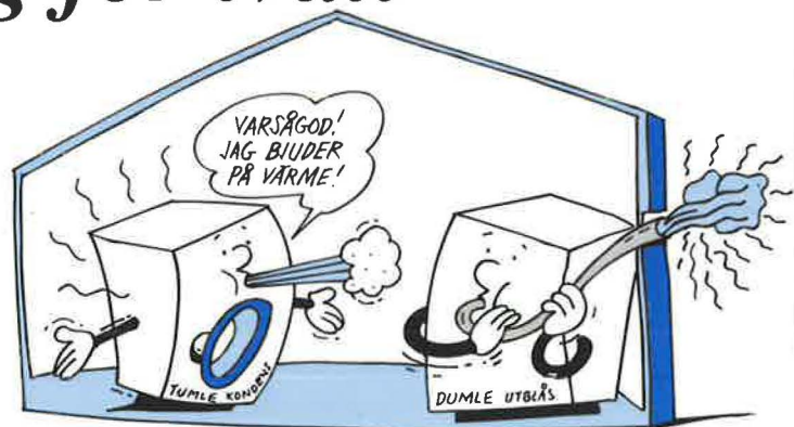
Bild 8: En kondensumlare ger mer nyttig värme till rummet än en utblåstumlare.
